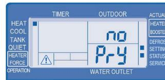
6. Priorité chauffage (YES/NO, standard: NO) cette valeur doit rester configurée NO, sinon l'eau chaude est chauffée uniquement avec le résistance électrique.
