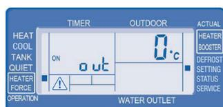
6. Température extérieure pour activation supplémentaire de la résistance électrique (-15 à +20 °C, Std. 0 °C)
