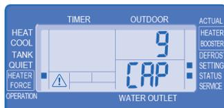
2. Sélection de la puissance du chauffage électrique d'appoint de l'appareil interne (3, 6 et 9 [selon taille], standard: max.)
