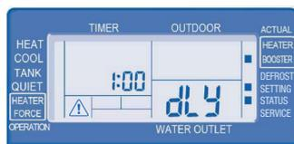
**10.** Temporisation d'allumage de la résistance électrique thermoplongeante (20 min. à 1 h. 35 min., standard: 1 h.) configuration de la durée de temporisation d'allumage du chauffage d'appoint du ballon d'eau chaude, lorsque la température du ballon n'est pas atteinte.
