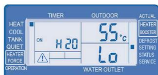
3. Température de consigne de sortie de l'eau pour mode chauffage à température extérieure basse (25 à 55 °C, Std. 55 °C)
