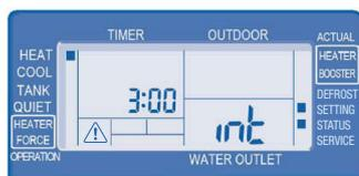
**7.** Durée de chauffe du chauffage (30 min. à 10h., standard: 3h.) configuration de la période de chauffe du système de chauffage pour les modes chauffage et chauffage d'eau chaude.
