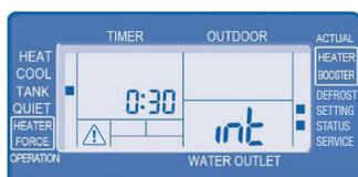
**8.** Durée de chauffe pour chauffage d'eau chaude (5 min. à 1 h. 35 min., standard: 30 min.) configuration de la période de chauffe de l'eau chaude pour les modes chauffage et chauffage d'eau chaude.
