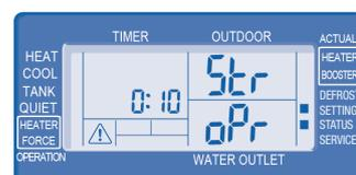
**14.** Durée de désinfection (5 min. à 1 h., standard: 10 min.) configuration de la période nécessaire, pour maintenir une température de ballon requise pour la désinfection.
