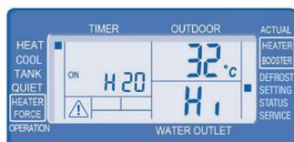
4. Température de consigne de sortie de l'eau pour mode chauffage à température extérieure élevée (25 à 55 °C, Std. 55 °C)
