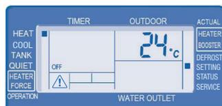
5. Température de consigne pour désactivation du mode chauffage (température limite de chauffage, 5 à 35 °C, Std. 24 °C)
