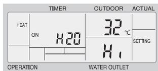
4. Température de consigne de sortie de l'eau pour mode chauffage à température extérieure élevée (25 à 55 °C, Std. 55 °C)
