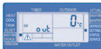
6. Température extérieure pour activation supplémentaire de la résistance électrique (-15 à +20 °C, Std. 0 °C)
