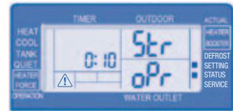
14. Durée de désinfection (5 min. à 1 h., standard: 10 min.) configuration de la période nécessaire, pour maintenir une température de ballon requise pour la désinfection.
