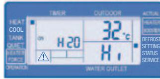
4. Température de consigne de sortie de l'eau pour mode chauffage à température extérieure élevée (25 à 55 °C, Std. 55 °C)
