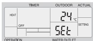
5. Température de consigne pour désactivation du mode chauffage (température limite de chauffage, 5 à 35 °C, Std. 24 °C)
