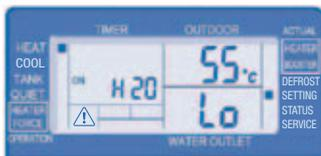
3. Température de consigne de sortie de l'eau pour mode chauffage à température extérieure basse (25 à 55 °C, Std. 55 °C)
