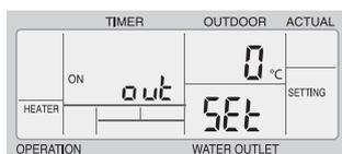
6. Température extérieure pour activation supplémentaire de la résistance électrique (-15 à +20 °C, Std. 0 °C)
