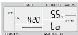
3. Température de consigne de sortie de l'eau pour mode chauffage à température extérieure basse (25 à 55 °C, Std. 55 °C)
